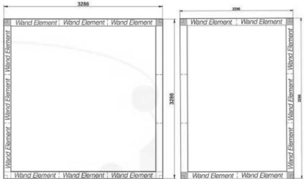
**Das Saunahaus 3m x 5m wird aus zwei Rahmen mit 3m x 3m und 2m x 3m Abmessung gebildet. Diese Konstruktion stellt die optimale Stabilität sicher.**
